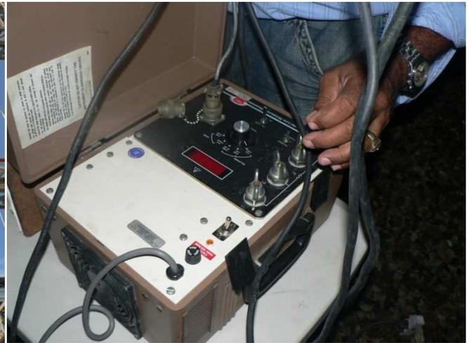
Pruebas Eléctricas (velocidad apertura cierre, resistencia de contacto, high pot, ect.) a aisladores y cuchillas seccionadoras, Subestación Turbo Gas AES Itabo.
